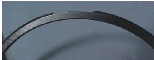
Fig. 3.4.2 Chipped contact face
